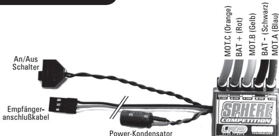
**EMPFÄNGERANSCHLUSSKABEL:** Dieser LRP Regler ist mit dem LRP-Multicon-Empfängerkabel ausgestattet und passt im Anlieferungszustand in alle handelsüblichen Empfänger.
