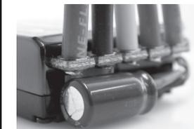
Montieren Sie den Power-Kondensator an einer crashgeschützten Stelle. Am besten direkt unter den Lötaschen (siehe Bild) und befestigen diesen mit doppelseitigem Klebeband.
