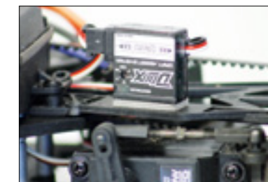
Die D-Box stabilisiert das Modell elektronisch durch einen Kreisel. Wenn die Wirkrichtung nicht stimmt, muss man sie auf dem Kopf montieren
