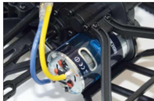
Beim Antriebsaggregat handelt es sich um einen grundsoliden Bürstenmotor
