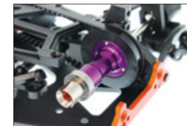
Das Vorderachsdifferenzial wird durch einen Freilauf ersetzt. Er ermöglicht eine Handbremsfunktion
