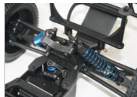
Sturzstreben und Lenkstangen sind nicht verstellbar
