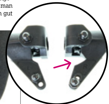
Um den Lenkausschlag zu vergrößern, muss man die Lenkhebel bearbeiten
