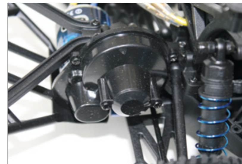
Der Getriebedeckel bietet einen wirksamen Schutz für Slipper, Ritzel und Hauptzahnrad
