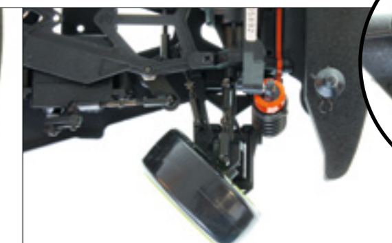
Um den Lenkausschlag zu vergrößern, muss man die Lenkhebel bearbeiten
