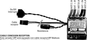
Este variador LRP está equipado con cable receptorLRP Multicon. Podrá ser utilizado con todos los receptores normales.
