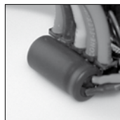
Monte el condensador en un lugar protegido de los golpes. El mejor lugar es en la parte trasera del variador (vea la imagen). Asegúrelo con cinta de doble cara.
