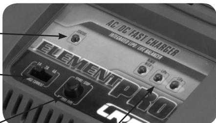
**LEDs DE TIPO DE BATERÍA:** Indica el tipo de batería seleccionada.
