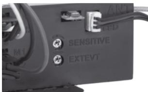
**LED:** Conexión para la luz LED.
