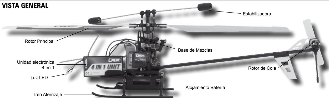
**Rotor de Cola** - Debido al esfuerzo de torsión del rotor principal, el helicóptero se ve arrastrado por esa fuerza. Para estabilizar el helicóptero esa torsión se tiene que compensar. Esto es lo que hace el rotor de cola, compensar esa fuerza aplicando una fuerza opuesta a la rotación generada por el rotor principal.
