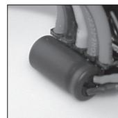
Montieren Sie den Power-Kondensator an einer crashgeschützten Stelle. Am besten direkt neben den Fahrtenregler (siehe Bild) und befestigen diesen mit doppelseitigem Klebeband.
