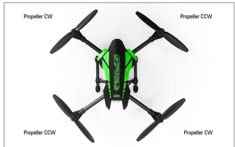
Asegúrese de reemplazar SIEMPRE la hélice dañada por una hélice del MISMO tipo. (CW/CCW)
