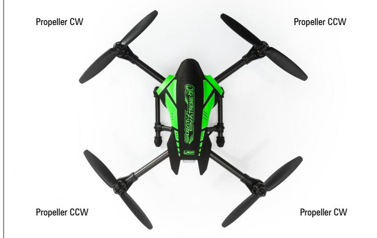
Assurez-vous de toujours remplacer une hélice par une nouvelle hélice de la même orientation (CW/CCW – sens horaire/antihoraire).
