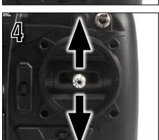
Natürlich können Sie diese individuellen Steuerbefehle zu komplexeren Steuerbefehlen kombinieren. Zum Beispiel: Wenn Sie den RECHTEN Steuerknüppel gleichzeitig nach vorne und nach links neigen, dann wird die Gravit nach vorne links fliegen.
