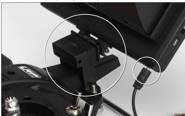
Stellen Sie sicher, dass der LCD-Empfänger während des Ladens AUS ist.
