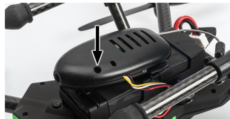
Ab Werk ist die Kamera so eingestellt, daß Sie immer auf CH1 sendet. Wenn Sie ein kleines Werkzeug nehmen und den Knopf der Kamera einmal drücken, werden Sie ein „Klick“ hören und fühlen und die Kamera schaltet zum nächsten Kanal, welcher CH2 wäre. Jedes weitere Drücken des weißen Knopfes läßt die Kamera zum nächst höheren Kanal schalten. Wenn der letzte Kanal erreicht ist (CH6) und der Knopf erneut gedrückt wird, so springt die Kamera wieder auf CH1 und das ganze geht von vorne los.
