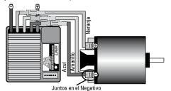
Realice una segunda comprobación de seguridad ante de conectar el variador a la batería PRECAUCION: Si la batería se conecta con la polaridad invertida, su variador resultara destruido.
