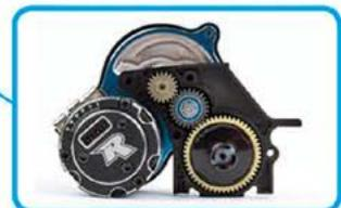
Transmisión Stealth™ con 3 engranajes verticales y eje de transmisión en aluminio ligero.
