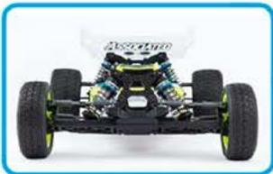
Soporte de amortiguadores de carbono reforzado y trapecios delanteros planos con tres posiciones de anclaje de amortiguadores.
