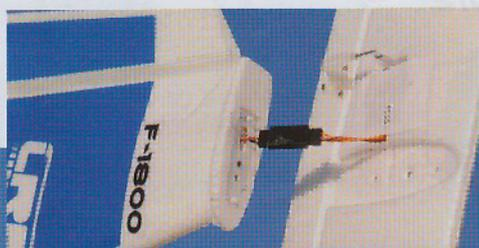
El estabilizador es fácilmente desmontable lo que facilita el transporte, el conector del servo se esconde en el interior.
