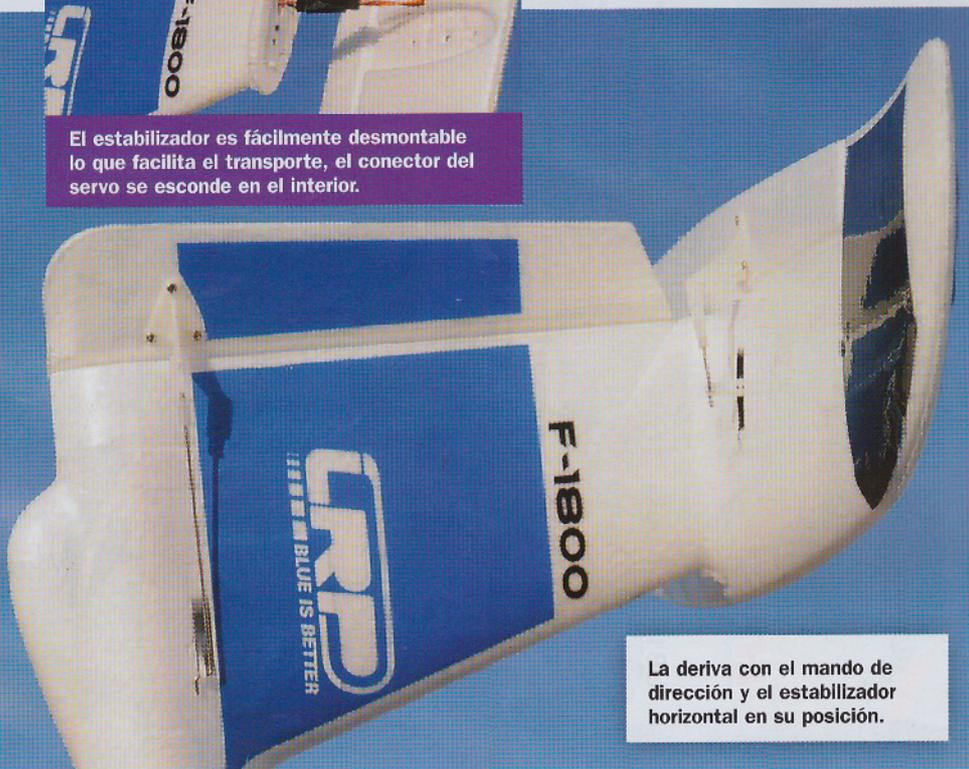
La deriva con el mando de dirección y el estabilizador horizontal en su posición.
