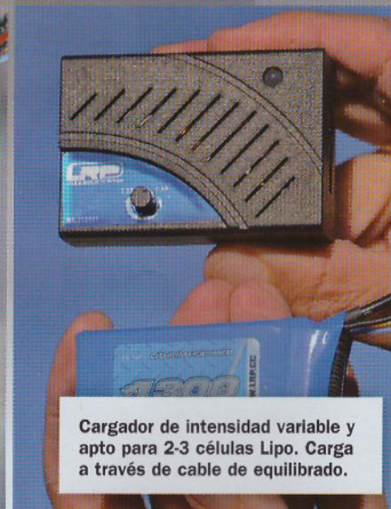
Cargador de intensidad variable y apto para 2-3 células Lipo. Carga a través de cable de equilibrado.
