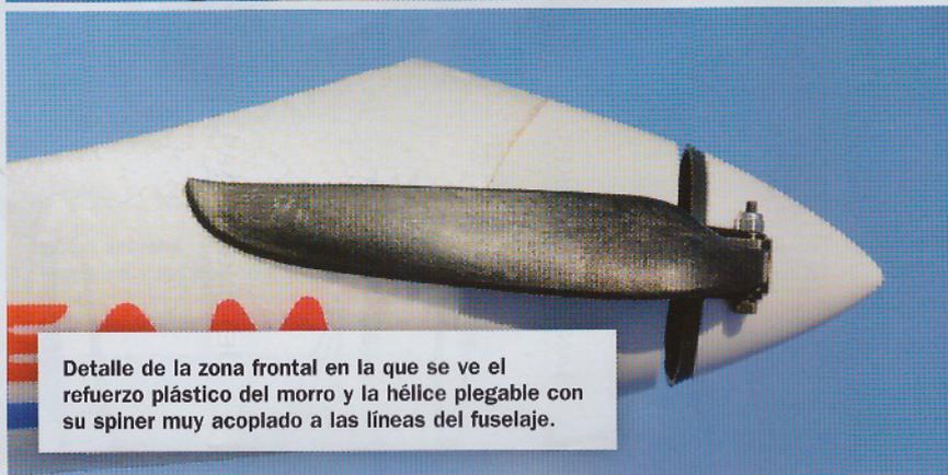
Detalle de la zona frontal en la que se ve el refuerzo plástico del morro y la hélice plegable con su spinner muy acoplado a las líneas del fuselaje.
