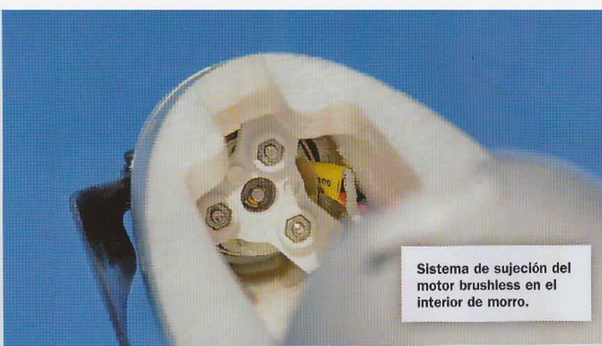
Sistema de sujeción del motor brushless en el interior de morro.
