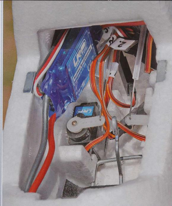
La batería de 3S 1300 mAh incluida es bastante potente, incluso podría volar con una 2S ralentizando la velocidad pero aumentando la autonomía. En el interior componentes de calidad como caracteriza la firma LRP.
