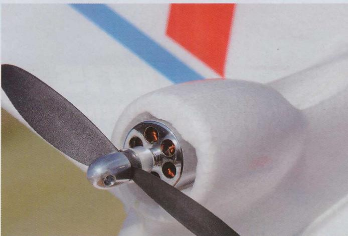
La configuración de semialas permite aminorar el volumen del avión durante el transporte. Motor brushless trasero: si decidiéramos moverlo con Lipo de 2S sería conveniente aumentar la hélice 1/2 pulgada.
