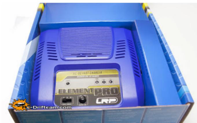
La diferencia principal, es que el cargador Pro puede cargar y balancear baterías Lipo y LiFe de 1 a 3 elementos, y además, como se observa en esta imagen, el Element Pro cuenta con una segunda toma de alimentación tipo pinzas cocodrilo, que permite conectarlo a una fuente de alimentación externa de 11 a 15v en continua. Muy útil para poder cargar las baterías cuando estamos fuera de casa
