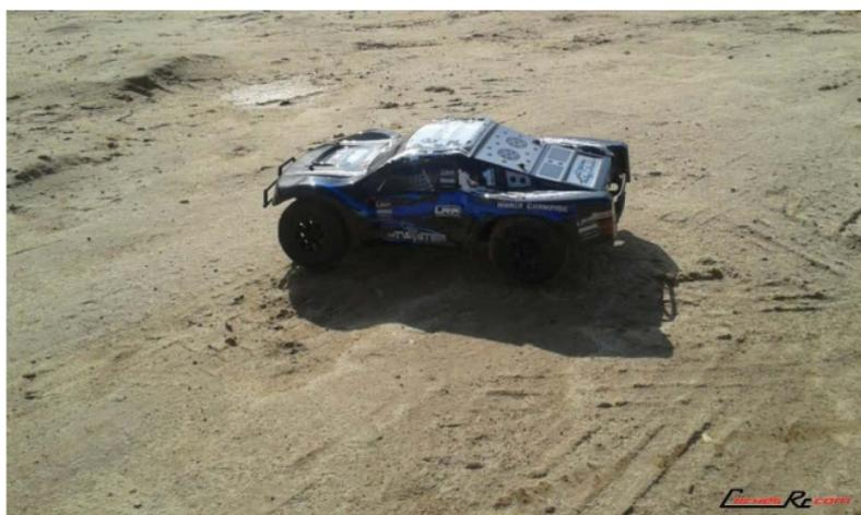
Al ser un coche tracción trasera permite una buena distribución de los pesos, alojando la Bateria de manera longitudinal central dejándonos un pequeño ajuste de esta mediante una espuma de alta densidad, con la que cambiando su posición podemos adelantar la batería para conseguir mas dirección y quitar tracción trasera.
