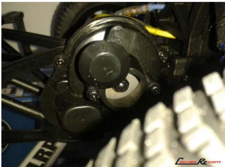
El servo de direccion es 3Kg piñonera de plastico, se nos hace corto para el tipo de coche que es, y lo notamos rapidamente en la direccion que no es muy rapida debido al peso de las enormes ruedas que calza este chasis, ruedas que nos han proporcionado un estupendo agarre en las diferentes superficies en la que lo hemos rodado
