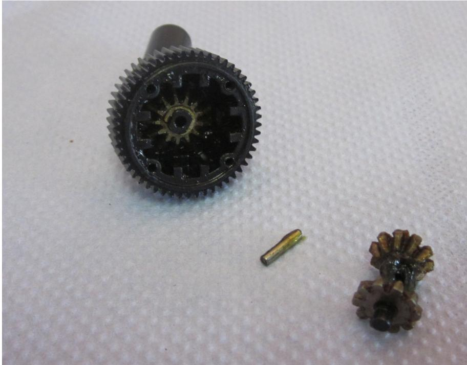
Lösen Sie den E-Clip des Kegelzahnrades mit Hilfe eines Schraubendrehers, oder einer Zange.
