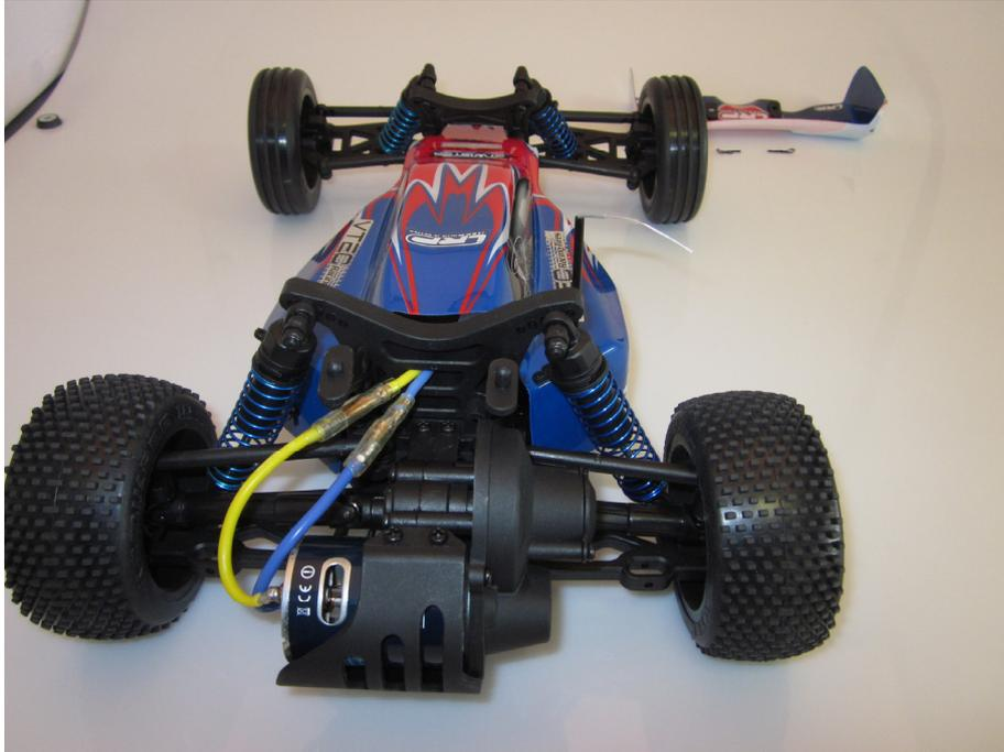
Trennen Sie die Motorkabel und lösen Sie die beiden gekennzeichneten Schrauben.
