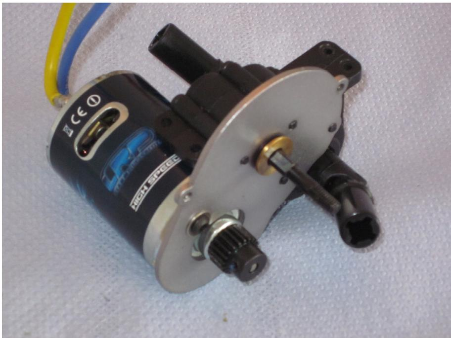
Montieren Sie anschliessend die Druckscheiben, Schlipperscheiben und Hauptzahnrad wie abgebildet. Achten Sie bei den Slipperscheiben auf die Aussparungen. Diese müssen mit dem Hauptzahnrad übereinstimmen.
