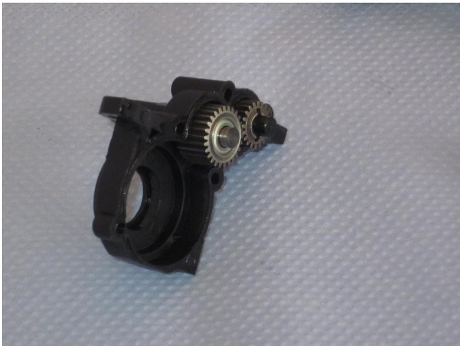
Zerlegen Sie nun das Differential. Lösen Sie die 4 Kreuzschlitzschrauben und entnehmen diese.
