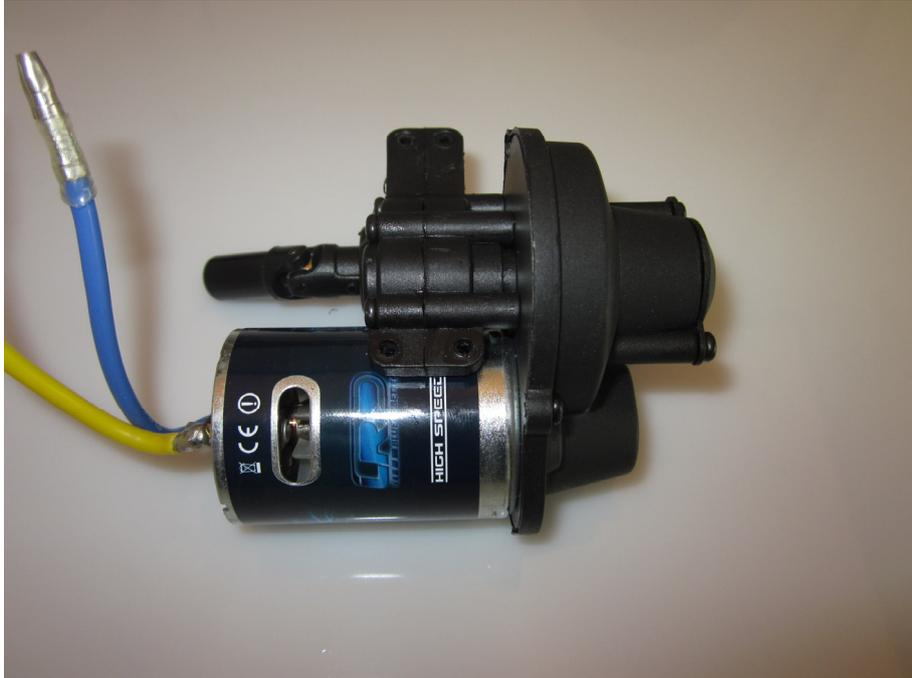
Lösen Sie die zwei Schrauben des Getriebedeckels und nehmen Sie diesen ab.
