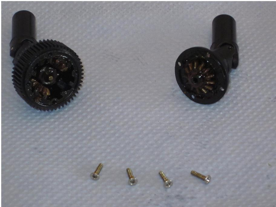
Lösen Sie den E-Clip des Kegelhahnrades mit Hilfe eines Schraubendrehers oder einer Zange.
