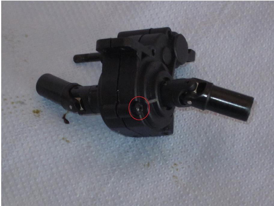
Setzen Sie die Motorplatte an das Getriebegehäuse und montieren diese mit den vier Schrauben. Ziehen Sie auch die Schraube aus dem vorherigen Bauschritt an.
