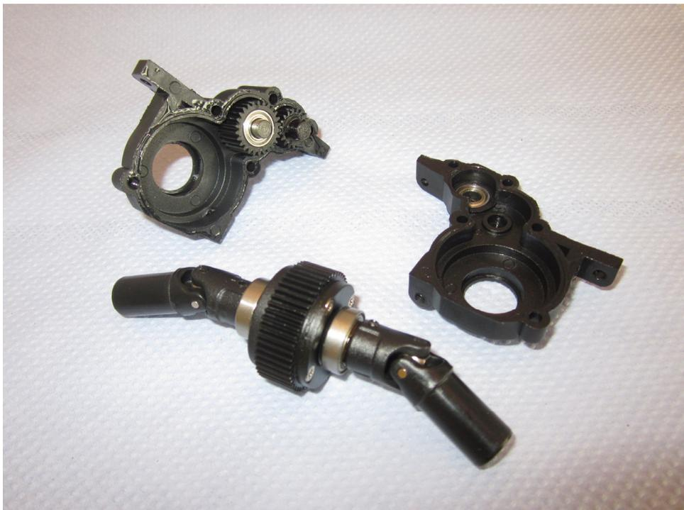
Entnehmen Sie nun das Zwischenzahnrad und die Slipperwelle.
