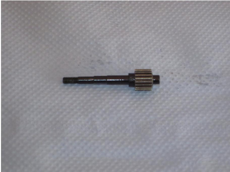
Setzen Sie die Slipperwelle mit dem Metallzahnrad in das Getriebegehäuse ein.
