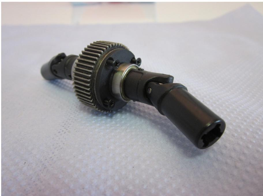
Setzen Sie das Differential in das Getriebegehäuse ein und fetten Sie die Zahnräder.
