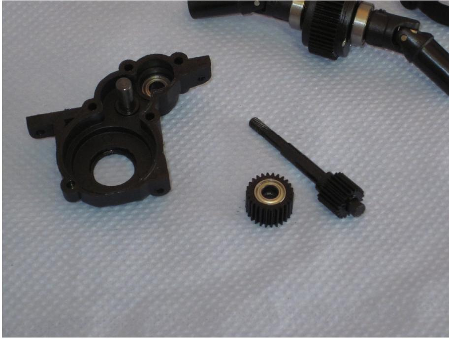
Jetzt entnehmen Sie die Kugellager aus dem Zwischenzahnrad.
