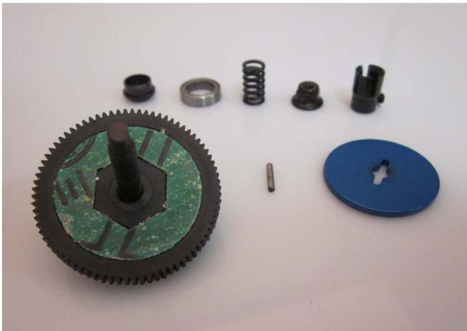
Setzen Sie den Mitnehmerstift wieder in die Welle ein & montieren anschließend der Metallscheibe.
