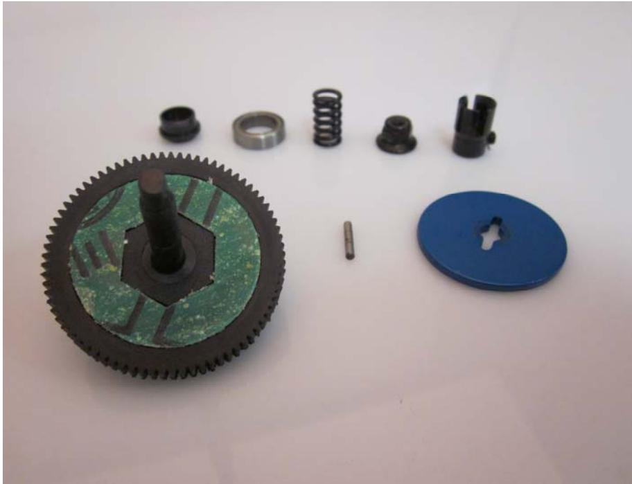
Ziehen Sie das Hauptzahnrad von der Slipperwelle.
