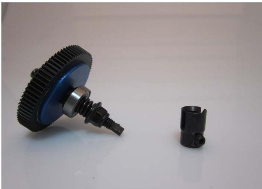
Lösen Sie die selbstsichernde Mutter, um die Druckfeder zu entspannen.
