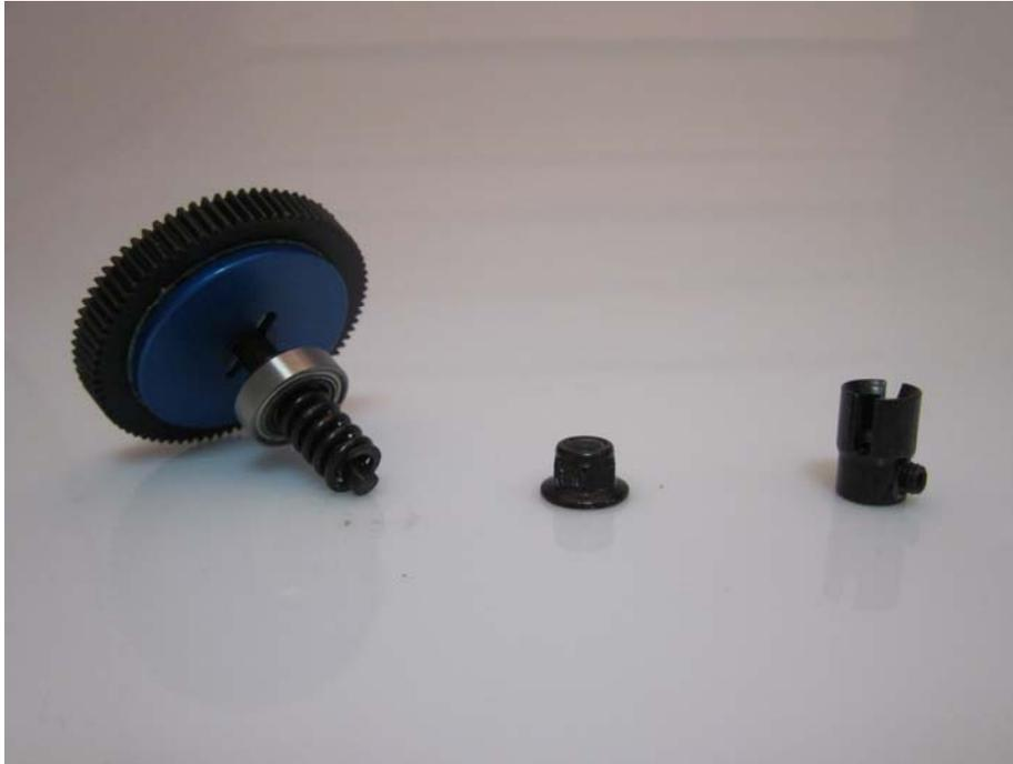
Entfernen Sie die Feder, das Kugellager und die Führungshülse der Feder.
