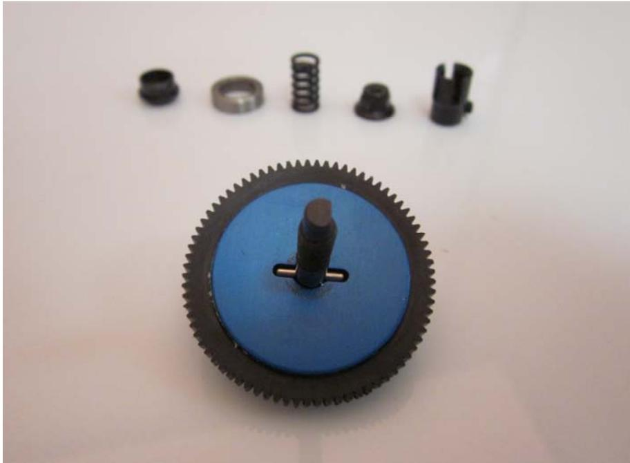
Setzen Sie die Führungshülse auf die Welle. Anschließend das Kugellager und die Feder. Diese spannen Sie dann wieder mit der selbstsichernden Mutter. Einstellung des Slippers wie auf Seite 1 beschrieben.
