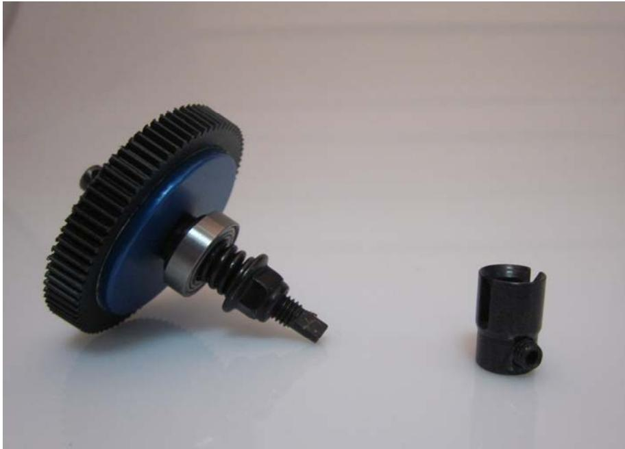
Zuletzt montieren Sie den Mitnehmer für die Mittelwelle. Achten Sie darauf, dass die Madenschraube auf der Abflachung der Welle sitzt. Setzen Sie die Madenschraube mit Schraubensicherungslack ein.
