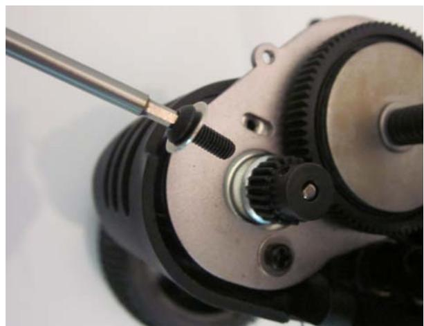
Ziehen Sie nun die Neue Motorbefestigungsschraube an. Die zweite Motor-Befestigungsschraube tauschen Sie bitte in gleicher Reihenfolge. Achten Sie auch bitte hier auf die Unterlegscheibe.
