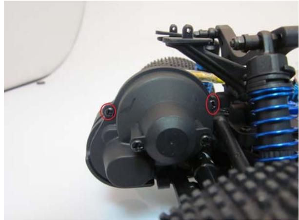
Nehmen Sie die Getriebekappe ab und lösen sie eine Kreuzschlitzschraube des Motors. Achten sie auf die Unterlegscheibe. Nehmen Sie die Unterlegscheibe, und stecken diese auf die Innensechskantschraube.
