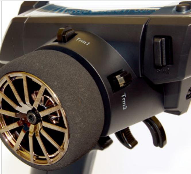
Rund um das griffige Lenkrad wurden insgesamt drei Trimmschalter platziert, mit denen direkt auf Funktionen zugriffen werden kann. Welche Funktionen das sind, lässt sich frei festlegen
