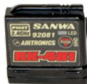
Mit zum getesteten Set gehörte auch der fast schon winzige 4-Kanal-Empfänger mit der Bezeichnung RX-481, der auf ein externes Antennenkabel verzichtet
