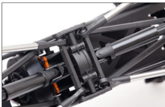
HPI verwendet solide Links aus Metall. Sie haben die Eigenschaft, gut über Steine und Geröll zu rutschen, was bei einem Crawler von Vorteil ist
