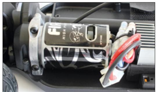
15 Turns hat der 540er-Brushlessmotor, der in der Alu-Motorhalterung platziert und bereits am wasserdichten LiPo-fähigen Controller angeschlossen ist
