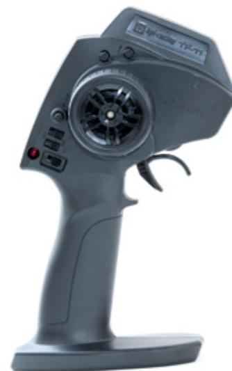
Der Sender verfügt über 2,4-Gigahertz-Technik. Er liegt gut in der Hand und besitzt diverse Einstellrädchen, um Setup-Arbeiten am Sender vorzunehmen. So lassen sich Nullpunkte oder der Geradeauslauf einfach beeinflussen
