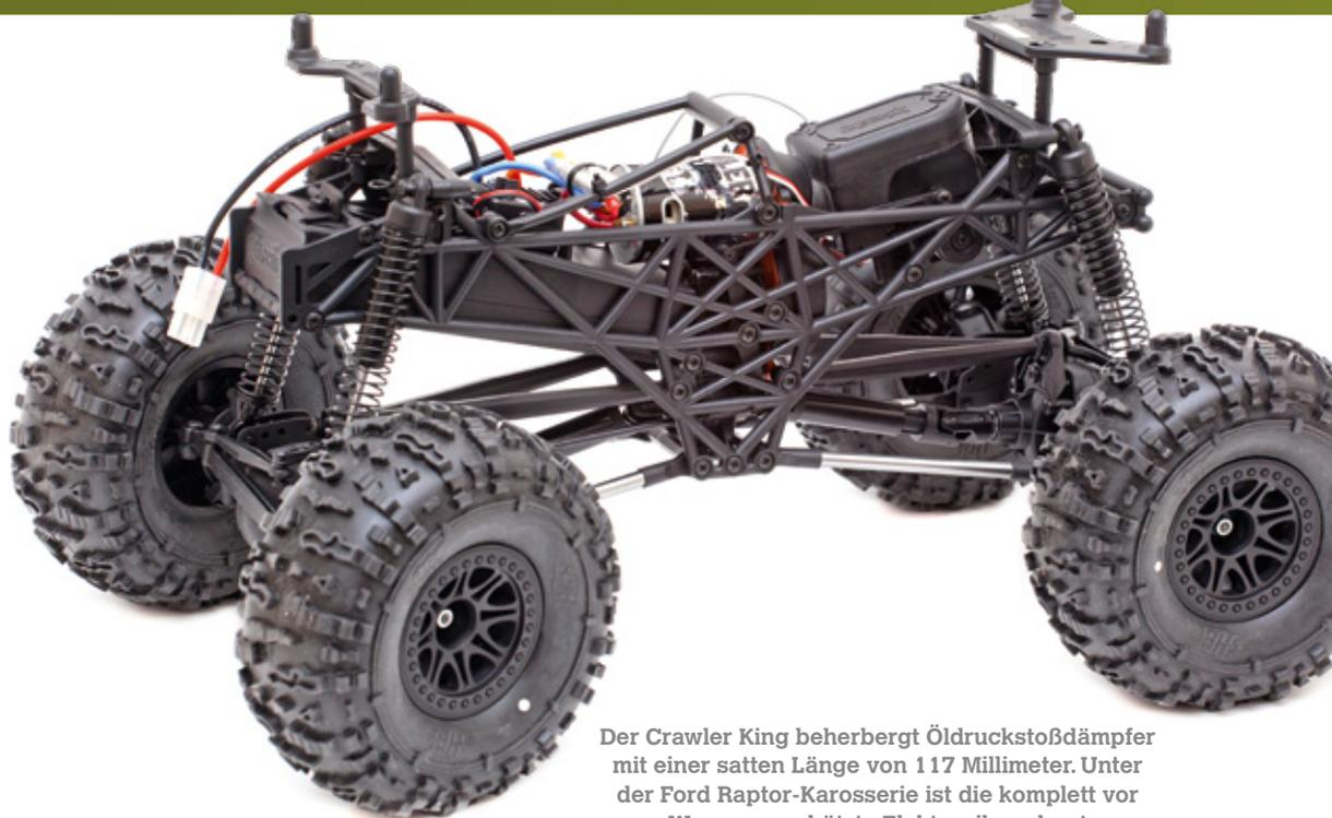
Der Crawler King beherbergt Öldruckstoßdämpfer mit einer satten Länge von 117 Millimeter. Unter der Ford Raptor-Karosserie ist die komplett vor Wasser geschützte Elektronik verbaut
