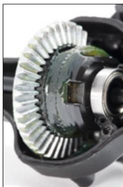
Ab Werk ist der HPI Crawler King an den entscheidenden Stellen gut gefettet. Zu Wartungszwecken muss nur der Differenzialdeckel demontiert werden
