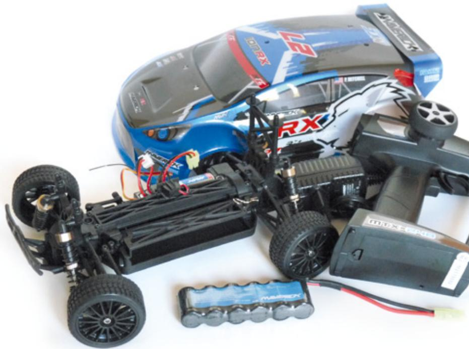
Diese Teile sowie ein vierer Trockenbatterienset und die Dokumentation stellen den kompletten Lieferumfang eines ION RX-Modells dar. Das Tüpfelchen auf dem I wären Akkus für den Sender samt Umschalter am Lader für das Aufladen des Senders und des Fahrakkus
