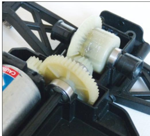
Neben einer guten Fettfüllung glänzen die Getriebe vor allem durch das geringe Spiel und die lastgerecht dimensionierten Zahnräder. Auch Feinheiten wie das Ritzelspiel oder die Abdichtung durch saubere Passungen wurden bei der Montage beziehungsweise Konstruktion des RTR-Modells beachtet
