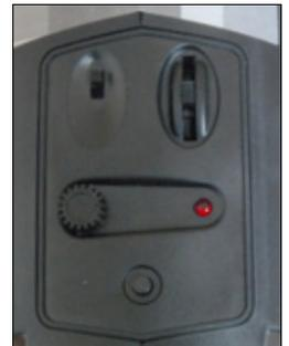
Servoreverse, Lenkungs- und Gastrimmung sowie eine Bind-Taste und der obligatorische Ein-aus-Schalter stellen die einzigen Einstellelemente des kleinen aber störsicheren Senders dar
