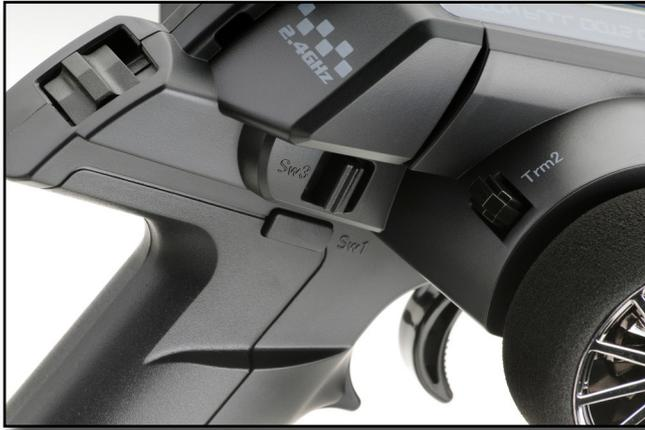
vollkommen genügend ist. Sie sind frei belegbar, Gas/Brems-Trimmung und Lenkungstrimmung wären hier am sinnvollsten.
