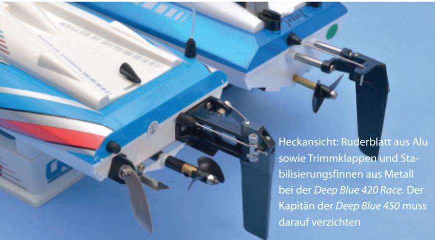
Heckansicht: Ruderblatt aus Alu sowie Trimmklappen und Stabilisierungsfinnen aus Metall bei der Deep Blue 420 Race. Der Kapitän der Deep Blue 450 muss darauf verzichten
