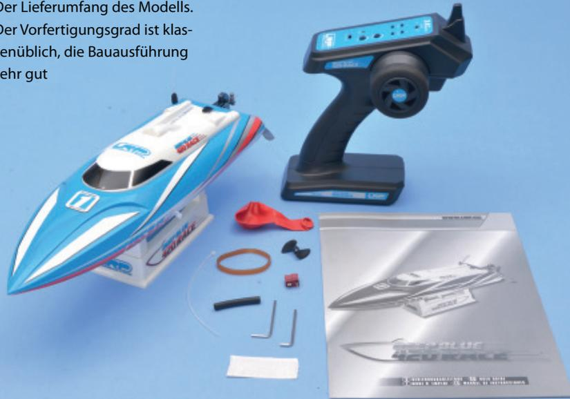
ke und eine Tube Wellenfett, außerdem die Stromversorgung für den Sender – vier AA-Zellen – und die Akkus mit Ladetechnik für den Antrieb des Rennbootes. Aber da ist die *Deep Blue 420*, dank ihrer geringen Abmessungen, sehr genügsam: Ein 3S-LiPo vom Typ *Deep Blue 420 Race-Expert Line* mit einer Kapazität von 1.800 m verhilft ihr zu imposanten Fahrleistungen. Unser Tipp: Lieber gleich zwei davon besorgen. Dann hat man länger Freude, ohne Nachladen zu müssen.
