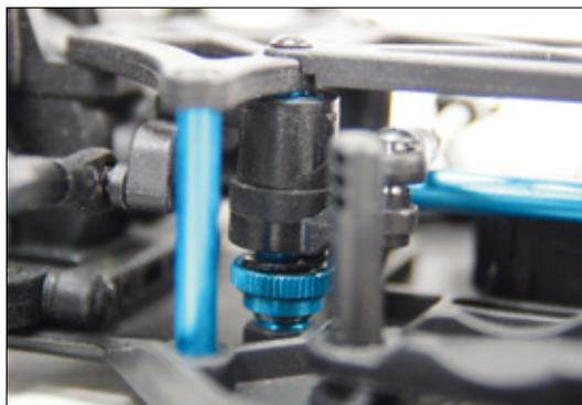
Ein Cam-Style-Servosaver schützt das Kunststoffgetriebe des Lenkservos
