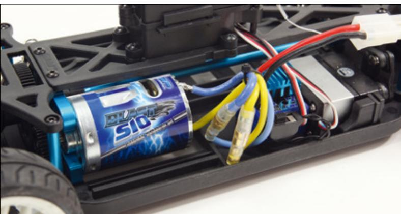
Der spritzwassergeschützter LRP AI Runner V2 Digital-Regler treibt den High Torque-Bürstenmotor an. Sein integrierter Lüfter hält die Temperaturen so gering wie nötig
