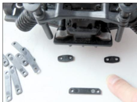
Auch diese Plastikplatten sind im Set enthalten. Im Bild sieht man die Anordnung, wie sie unter den Spurblocken vorne und hinten verbaut werden
