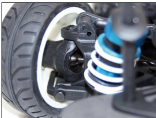
Die Vorderräder werden von CVD-Wellen angetrieben. Hinten kommen Knochen zum Einsatz
