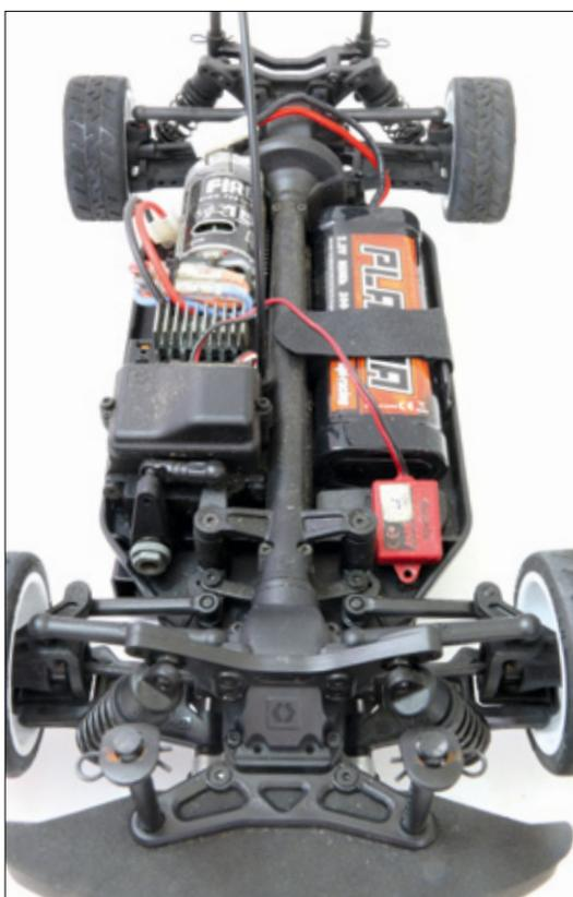
Ordentlich aufgebaut und sauber verkabelt. Vorne im Bild auf dem Servo sitzt die wasserdichte Box mit dem Empfänger
