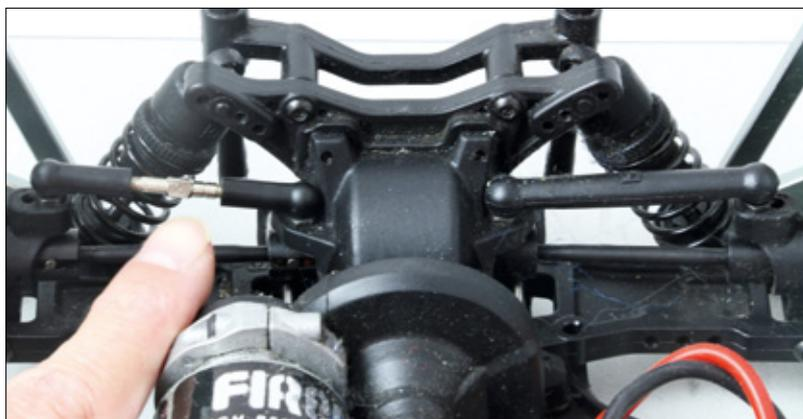
Links im Bild sieht man den verstellbaren Querlenker, rechts den Querlenker, der vormontiert ist
