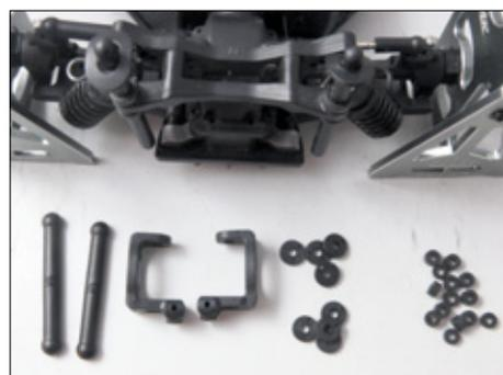
Die mitgelieferten Ersatz- und Tuningteile: Querlenker, C-Hubs für vorne, Dämpferkolben mit einem oder drei Löchern und verschiedene Plasticscheiben
