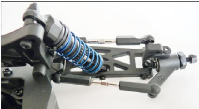
Die Ausstattung mit einigen Tuningteilen wie den Rechtslinks-Gewindestangen, den Kugellagern und leicht flexiblen Kunststoffen zeugt von einer soliden Basis, zumal auch die Stoßdämpfer sauber ansprechen, wenn auch die Federn teilweise etwas zu weich sind
