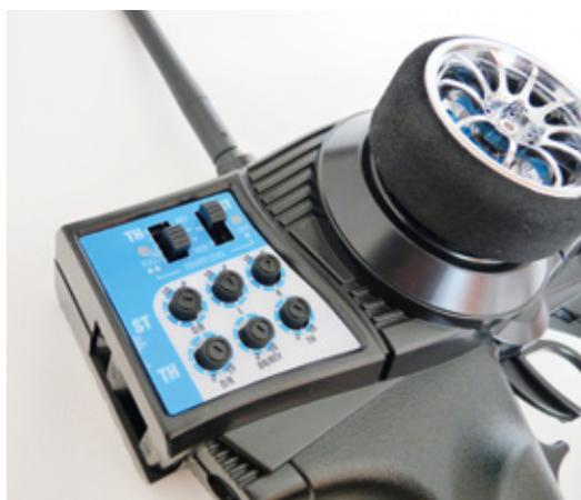
Die störstärkeren Sender verfügen neben Servoreverse und Trimmung auch über eine Begrenzung des maximalen Servowegs und eine Senderladebuchse zum Aufladen des aus vier Mignonzellen bestehenden Akkus
