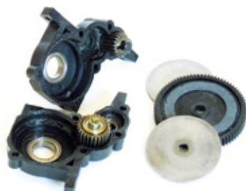
Das bei allen Modellen gleiche dreistufige Getriebe samt Rutschkupplung ist nicht nur sehr gut gefettet, sondern verfügt auch über einen Satz Stahlzahnräder. Lediglich das Motorritzel ist dem jeweiligen Modell und seinem Gewicht angepasst
