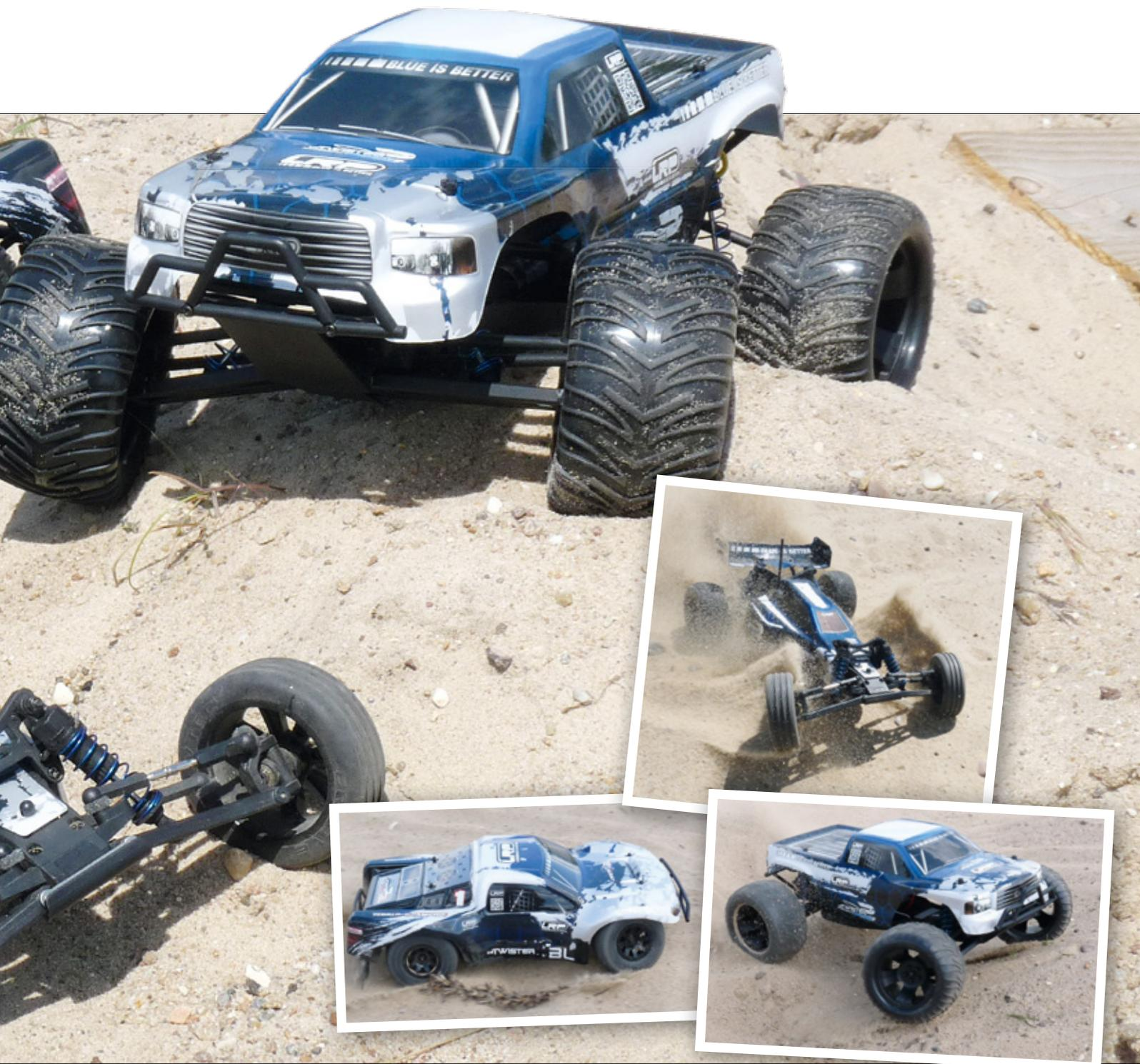
heran oder kann sogar durch Verdrehen des unteren Querlenkerhalters eine Änderung des Nachlaufs herbeiführen. Zusätzlich ermöglichen Einsätze bei den C-Hubs auch eine Veränderung des Radstands und über die serienmäßigen Rechts-links-Gewindestangen können der Sturz und die Spur verändert werden. Bei allen Modellen kommen sowohl vorne als auch hinten die sehr weit verbreiteten 12-Millimeter-Sechskantmitnehmer zum Einsatz.
