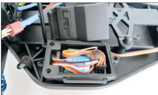
Die RC-Box ist sehr gut abgedichtet und beherbergt einen kleinen störsicheren 2,4-Gigahertz-Empfänger. Wer andere oder größere Empfänger nutzen möchte, kann die Box auch komplett entfernen
