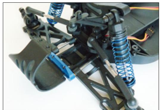
Die komplette Getriebebox lässt sich recht schnell demontieren und legt die Halterung der hinteren Querlenker frei
