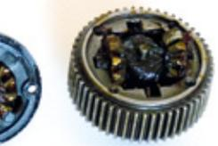
Ein Blick in das komplett aus Stahl gefertigte Differential zeigt zwar nur zwei kleine Kegelräder, diese verfügen aber über eine sehr grobe und stabile Verzahnung zum Übertragen hoher Kräfte
