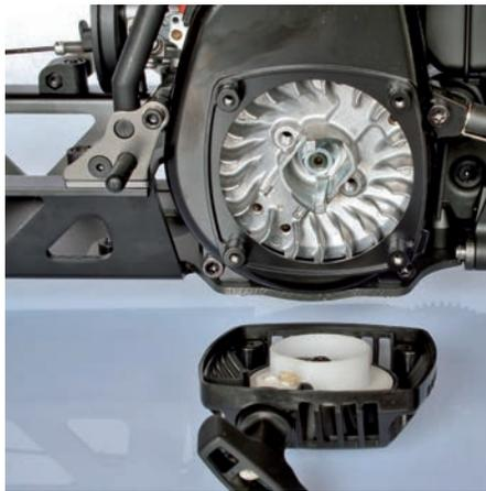
Unter dem Seilzugstarter sitzt das Lüfterrad, das auch bei hohen Temperaturen für ausreichende Kühlung sorgt.
