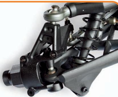
Der vordere Lenkhebel mit einer eher untypischen Bauform. Bei genauerer Betrachtung eine durchaus geniale Bauweise.
