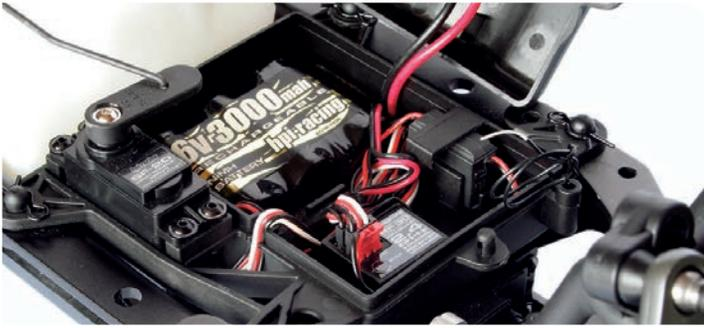
◀ Der Empfängerakku verfügt über zwei Anschlusskabel. Eines versorgt den Empfänger mit Strom und das zweite Kabel ist im Deckel der Box fixiert, um den Akku auch in eingebautem Zustand laden zu können.
