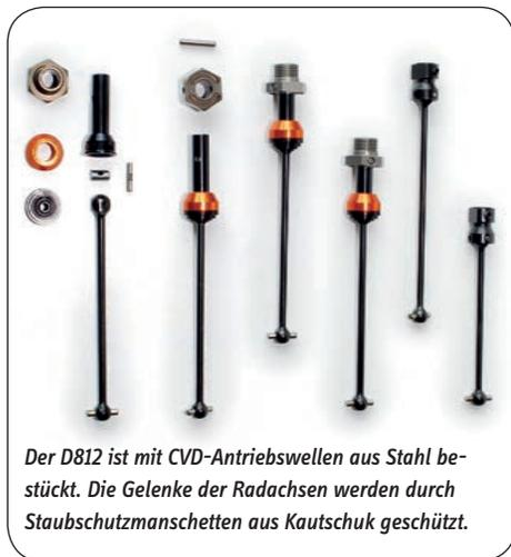
Der D812 ist mit CVD-Antriebswellen aus Stahl bestückt. Die Gelenke der Radachsen werden durch Staubschutzmanschetten aus Kautschuk geschützt.
