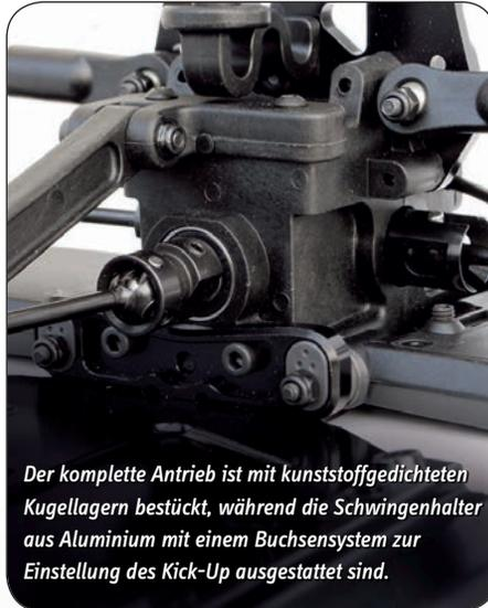
*Der komplette Antrieb ist mit kunststoffgedichteten Kugellagern bestückt, während die Schwingenhalter aus Aluminium mit einem Buchsensystem zur Einstellung des Kick-Up ausgestattet sind.*
