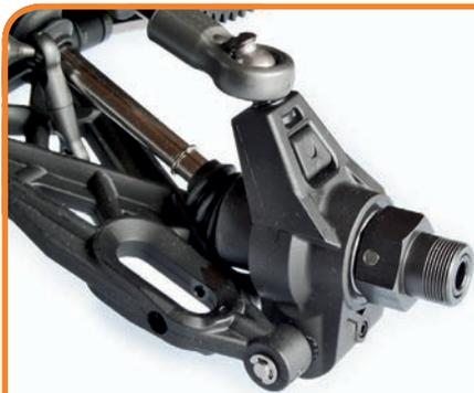
Der hintere Radträger ermöglicht die Einstellung von Sturz und Spur. Die Kunststoff- und Aluminiumteile machen einen sehr stabilen Eindruck.
