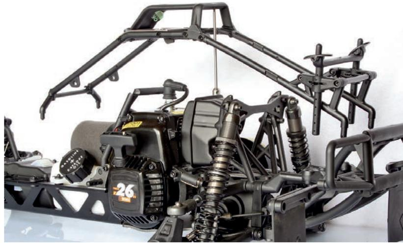
Auch der Käfig ist nur mit Splinten befestigt. Für die komplette Demontage muss jedoch die hintere Dämpferbrücke zumindest einseitig gelöst werden, da der Käfig unterhalb der Brücke befestigt ist.
