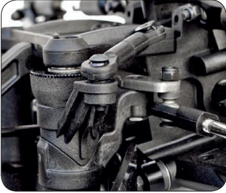
Der Servosaver wurde komplett überarbeitet und verstärkt, ein Schaumstoffring schützt die Feder und das Feingewinde vor Schmutz.
