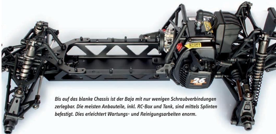
Bis auf das blanke Chassis ist der Baja mit nur wenigen Schraubverbindungen zerlegbar. Die meisten Anbauteile, inkl. RC-Box und Tank, sind mittels Splinten befestigt. Dies erleichtert Wartungs- und Reinigungsarbeiten enorm.
