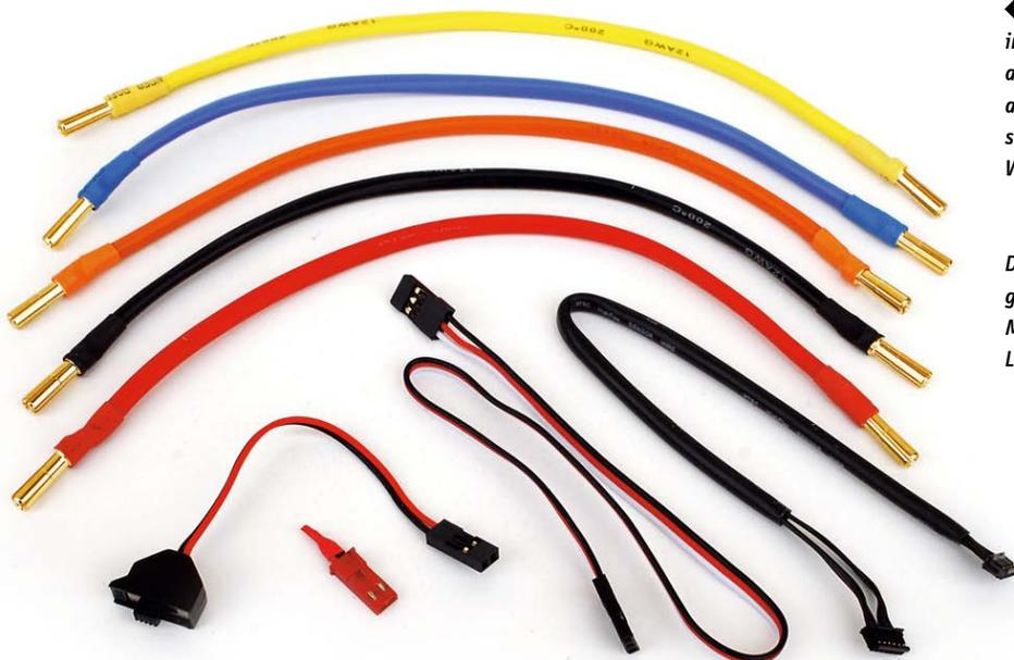
◀ Die mitgelieferten Anschlusskabel können, dank des integralen Stecksystems, jederzeit getauscht oder angepasst werden. Der kleine rote BEC-Stecker fungiert als Brücke und wurde selbst hergestellt. Er kann ersatzweise für den Schalter zum Einsatz kommen, der im Wettbewerb als Fehlerquelle gerne gemieden wird.
