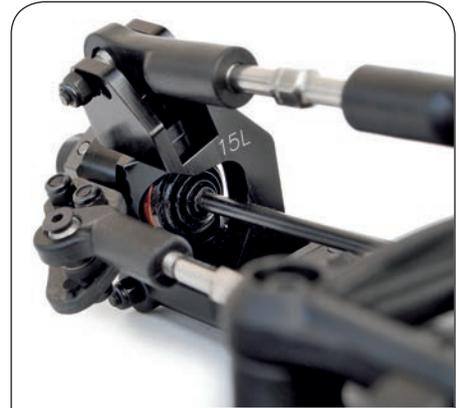
*Die Lenkhebelarme aus CFK haben drei verschiedene Fixpunkte für die Spurstangen. Die Lenkcharakteristik kann zudem durch unterschiedliche CFK-Plättchen, die optional erhältlich sind, verändert werden.*
