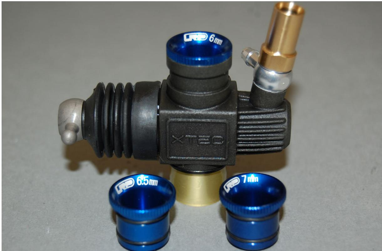
Bei den Justierungs-Möglichkeiten hat sich LRP für ein Dreinadel-Design entschieden, sodass der XTEC-Vergaser neben den obligatorischen High- und Lowspeed-Nadeln auch über eine Einstellschraube für den mittleren Drehzahlbereich verfügt. Letztere kann in der Regel allerdings beruhigt im Auslieferungszustand belassen werden. Wer dennoch an ihr Einstellungen vornehmen möchte, der sollte wissen, was er tut.
