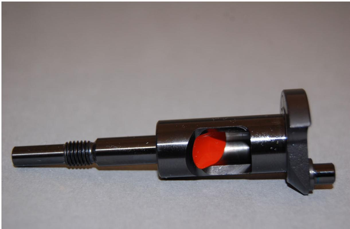
Auffälligste Veredelung der Spec2-Welle ist die orangefarbene Silikoneinlage. Durch sie wird es möglich, die Pleuellage konsequent hohl zu bohren und damit ihr Gewicht zu reduzieren. Außerdem gewährleistet die Einlage einen optimalen Gasfluss vom Vergaser zum Pleuellagegehäuse.
