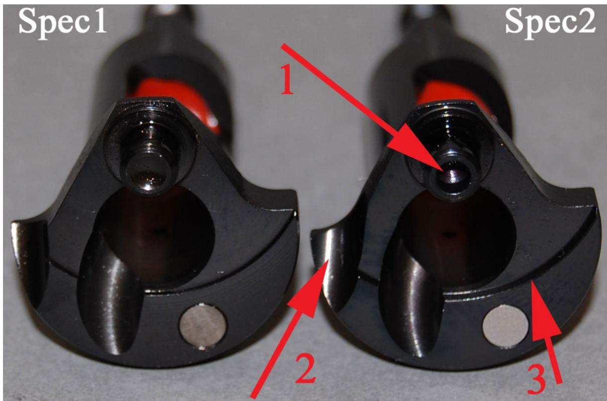
Im Gegensatz zur Welle des Spec1 ist der Kurbelzapfen des Spec2 hohl gebohrt (Markierung 1), was in erster Linie Gewichtsvorteile bringt. Weiterhin ist die Einfräsung im linken äußeren Bereich der Kurbelwange beim Spec2 stärker ausgeprägt (Mark. 2). Außerdem erkennt man eine stärkere Abstufung zwischen innerer und äußerer Kurbelwange bei der Welle der neuen Motorengeneration (Mark. 3).
