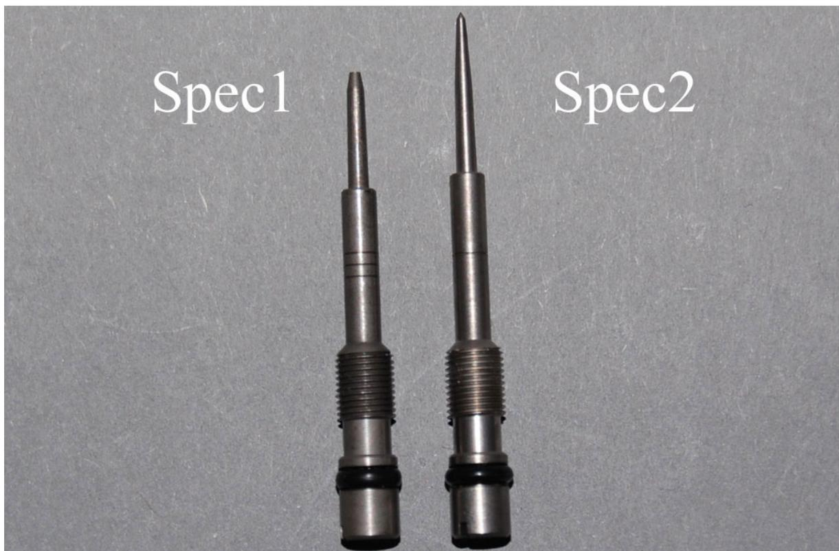
Da die Lowspeed-Nadel beim Öffnen und Schließen des Gasschiebers in die Middlespeed-Schraube hinein- und hinausfährt, müssen sie miteinander harmonisieren. Entsprechend wurde die Middlespeed-Schraube des Spec2 an dessen neue Lowspeed-Nadel angepasst.
