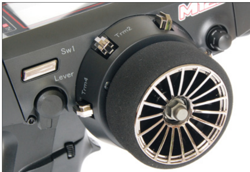
Schalter, Knöpfe und Regler wurden so positioniert, dass sie möglichst leicht erreichbar sind. Das Lenkrad lässt sich per mitgeliefertem Umbausatz tiefer und in unterschiedlichen Winkeln montieren
