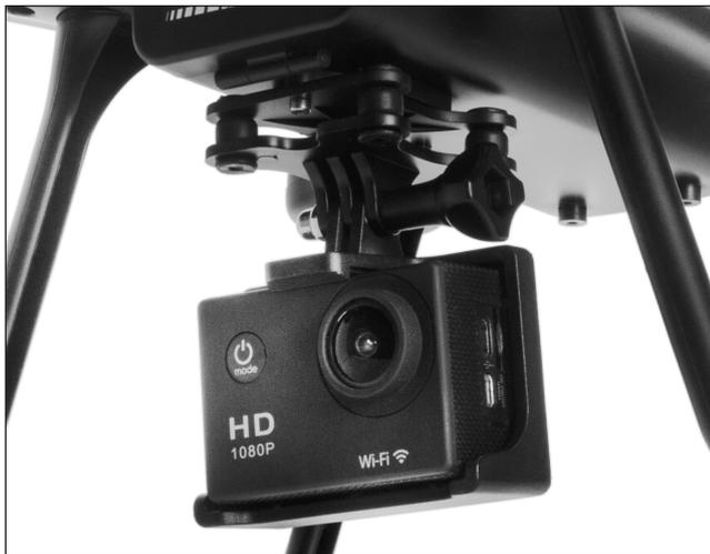
Stellen Sie sicher, dass sich die Kamera fest im Käfig befindet und dass der Käfig sicher mit der Halterungsplatte verbunden ist.
