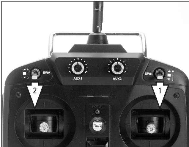
Wenn Sie Ihre Gravit über Startposition zurückkehren lassen und dort automatisch landen lassen wollen, müssen Sie sich im GPS-gestützten Flug-Mode befinden. Um Ihre Gravit in den GPS-Mode zu schalten, bringen Sie den rechten Kipp-Schalter (SWB) Ihrer Fernsteuerung in die unterste Position (Pos. Anmerkung: Sie können den „Return-to-Home“ aus jedem beliebigen Flug-Mode auslösen, wir empfehlen aber, wie beschrieben VORHER in den GPS-Mode zu schalten.
