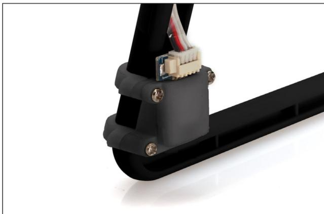
Neben vielen anderen elektronischen Komponenten ist Ihre Gravit auch mit einem Kompass-Modul ausgestattet. Der Kompass befindet sich im rückseitigen, unteren Teil des linken Landefußes, befestigt mit einer Kunststoff-Halterung. Da der Kompass sehr empfindlich ist, beachten Sie bitte die folgenden Punkte:
