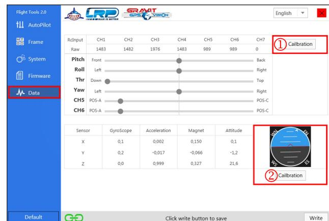
Das Data-Register wird dazu verwendet, ein wenig auf die Sensoren Ihres Flugkontrollers zu schauen und um die IMU und den Sender zu kalibrieren.
