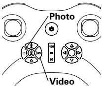
**Video-Taste:** Wenn Sie die Video-Taste einmal kurz drücken, startet die Action-Cam eine Video-Aufnahme in HD-Qualität. Sogar Ton wird in mono mit aufgenommen. Sie können eine laufende Aufnahme durch die rot blinkende LED hinten im Akkuschacht der Gravit erkennen. Drücken Sie die Video-Taste ein zweites Mal, um die Video-Aufnahme zu stoppen.
