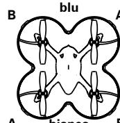
Le eliche hanno impresse le lettere "A" o "B", si raccomanda quindi di montarle correttamente. Per facilitare il cambio e lo smontaggio, si prega di utilizzare l'apposito strumento fornito.
