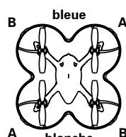
Les hélices sont marquées d'un "A" ou d'un "B", échangez les hélices en accord avec cette notation. Pour un remplacement facile, utilisez l'outil à hélice fourni.
