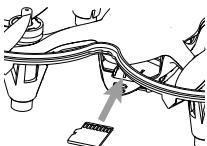
Sollte außer der grünen LED noch eine rote LED blinken, OHNE dass Sie eine Kamerafunktion ausgelöst hätten, so stimmt etwas mit der Micro-SD-Karte nicht. Eventuell ist die Karte voll, defekt oder kann von der Kamera nicht erkannt werden. Versuchen Sie, die Karte am PC zu formatieren. Sollte dies nicht helfen, versuchen Sie es mit einer anderen Micro-SD-Karte.
