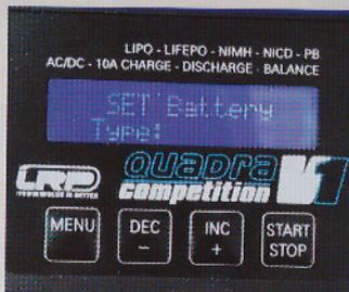
Se nos permite la carga de todo tipo de baterías, Lipo, Lifepo, Nihm...
