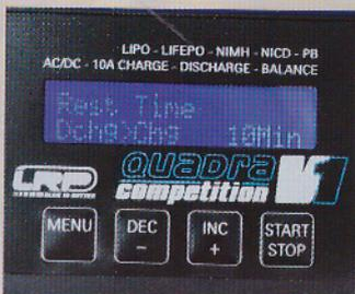
Temporizador de autoarranque, esta función nos permite programar el tiempo en el que se iniciará la carga o descarga de nuestra batería.
