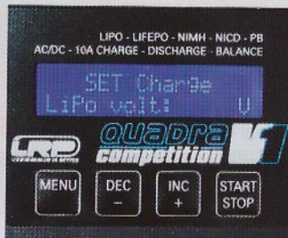
De forma manual nos permite seleccionar diferentes parámetros de carga, la más importante; la corriente de carga. En el manual hay un cuadro con recomendaciones de carga para cada batería.
