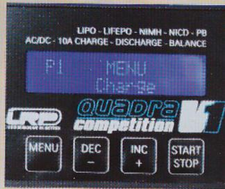
Menú configuración de descarga, para el tiempo de seguridad, interrupción por temperatura, etc.
