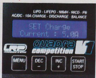
**ENTRE LAS MEDIDAS DE SEGURIDAD, APARTE DEL DELTA PEAK, DISPONEMOS, EN CASO DE UTILIZAR SENSOR DE TEMPERATURA, EL CORTE AUTOMÁTICO SI SE ALCANZA EL VALOR PRESELECCIONADO**
