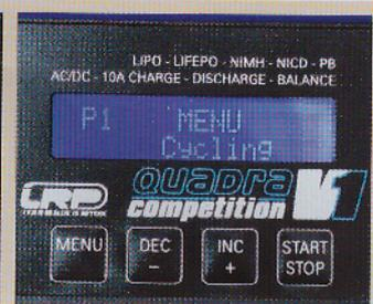
“Cycling”: muy útil para determinar el funcionamiento real de nuestra batería.
