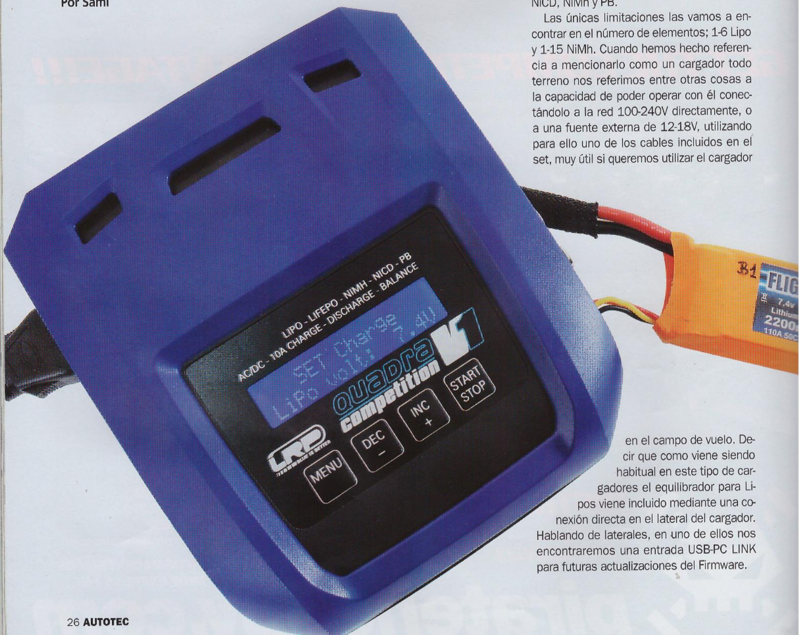
en el campo de vuelo. Decir que como viene siendo habitual en este tipo de cargadores el equilibrador para Lipo viene incluido mediante una conexión directa en el lateral del cargador. Hablando de laterales, en uno de ellos nos encontraremos una entrada USB-PC LINK para futuras actualizaciones del Firmware.
