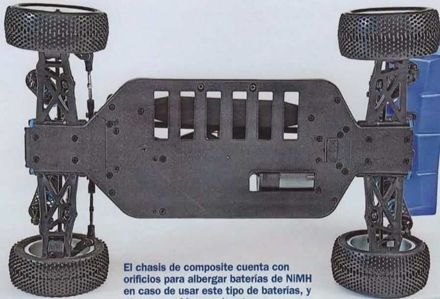
El chasis de composite cuenta con orificios para albergar baterías de NIMH en caso de usar este tipo de baterías, y otro para refrigerar el motor.
