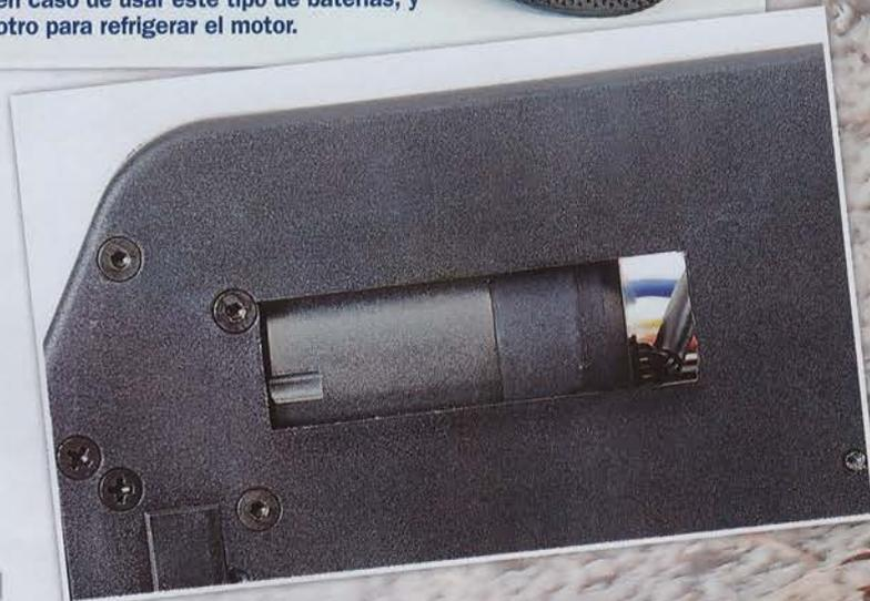
Detalle del orificio del motor por el que el aire ayudará a bajar la temperatura sin que entre demasiada suciedad en el interior del chasis.
