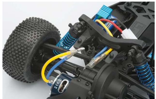
Lösen sie die beiden vorderen Schrauben des Getriebekastens und entfernen diese. Dann lösen Sie die beiden gezeigten Schrauben auf der Unterseite des Chassis an. Es ist nicht notwendig die Schrauben komplett zu entfernen. Die Getriebeeinheit kann so auf und ab bewegt werden, ohne dass die Teleskopkardans herausfallen.
