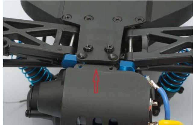
Setzen Sie die Schrauben des hinteren Schwingenhalters an, und ziehen diese fest. Achten Sie bitte weiterhin auf die korrekte Position der Kunststoffplatte. Zur Fixierung können Sie einen kleinen Schraubendreher benutzen. Ziehen Sie nun die Schrauben des Getriebegehäuses fest.
