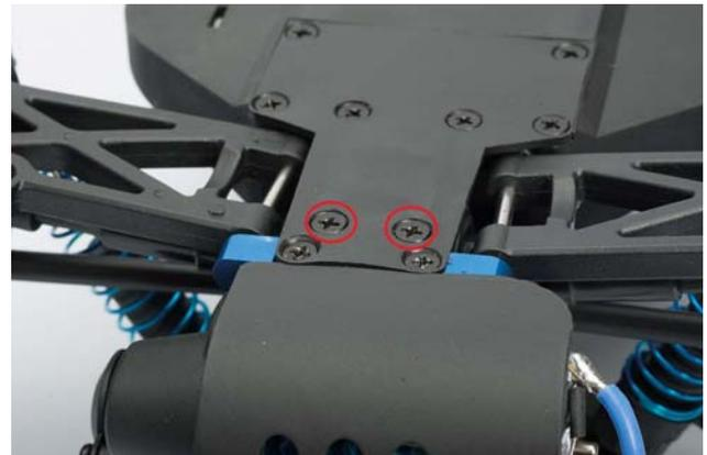
Setzen Sie bitte die beiden oberen Schrauben am Getriebegehäuse an und ziehen diese fest. Befestigen Sie dann den Motorschutz am Getriebegehäuse.
