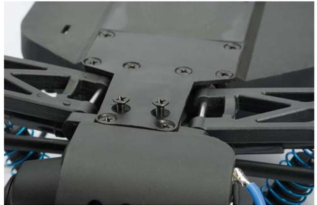
Lösen und entfernen Sie die beiden Schrauben der hinteren Schwingenaufnahme und entfernen diese. Nehmen Sie den Motorschutz nach hinten heraus **Vorsicht:** zwischen Chassisplatte und hinterem Schwingenhalter befindet sich eine Kunststoffplatte.
