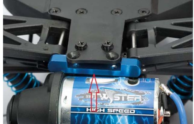
Legen sie die Kunststoffplatte, wie gezeigt, in den Schwingenhalter. Montieren Sie den Motorschutz zwischen Chassisplatte und Kunststoffplatte. Achten Sie darauf, dass die Platte nicht verrutscht.
