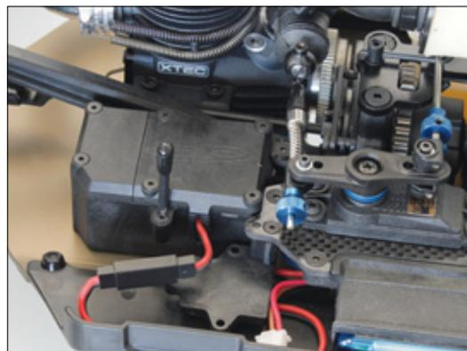
Die kleine RC-Box beherbergt den Empfänger. Wer einen Schalter montieren will, muss den Ausschnitt selber anfertigen
