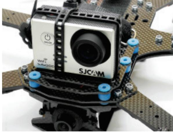
Die sechs blauen Dämpfungsgummis sind offensichtlich auf eine Action-Cam der 75-g-Gewichtsklasse (wie z.B. GoPro 3 Black Edition oder die im Bild zu sehende SJCam 5000\*) ausgelegt. Die Gummis entkoppeln die Kameraauflage sehr effizient vom Rahmen.
