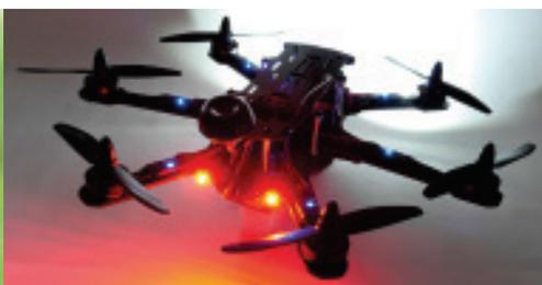
◀ Leuchtstarke rote (z.B. Superflux-) LEDs am Heck erleichtern es Verfolgen, Kollisionen zu vermeiden. Zur leichteren Lagebeurteilung beim Steuern per Beobachtung von außen habe ich auch vorn zwei Superflux-LEDs (weiß) angebracht. Die LEDs sind jeweils paarweise über eine 20-mA-Konstantstromquelle mit der Stromverteilerplatine verbunden.
