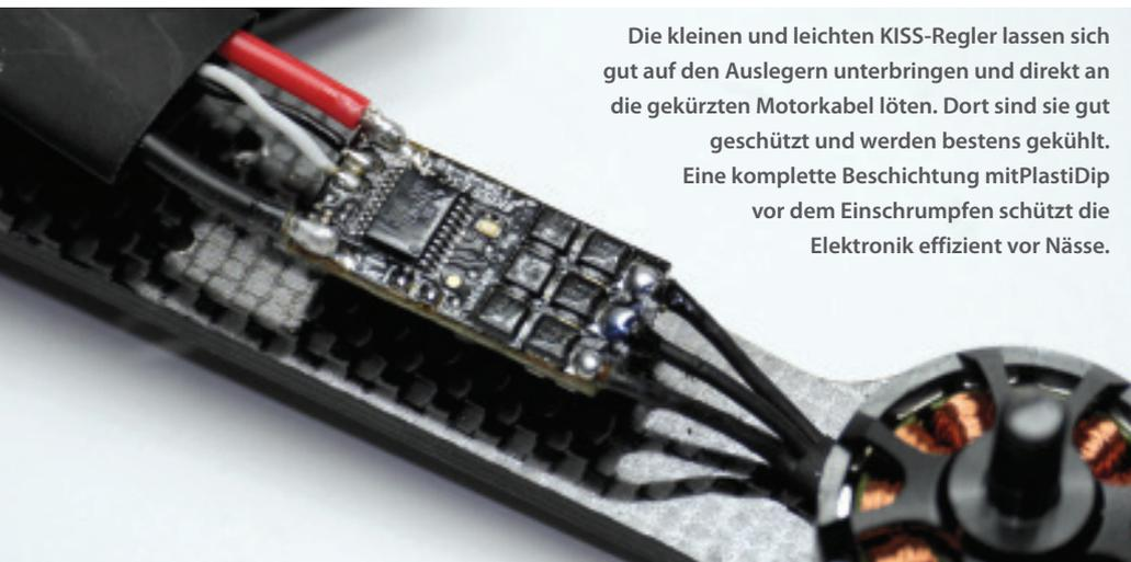
Die kleinen und leichten KISS-Regler lassen sich gut auf den Auslegern unterbringen und direkt an die gekürzten Motorkabel löten. Dort sind sie gut geschützt und werden bestens gekühlt. Eine komplette Beschichtung mit PlastiDip vor dem Einschrumpfen schützt die Elektronik effizient vor Nässe.
