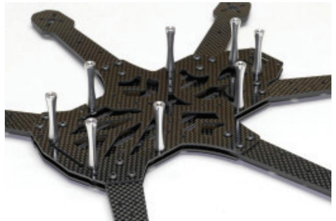
Die acht Alu-Abstandsbolzen zur Befestigung der oberen Chassisplatte sind – offenbar, um ein paar Gramm zu sparen – tailliert. Nebenbei sehen sie auch schick aus.
