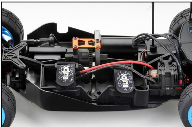
Der bereits erwähnte Brushless Motor sitzt in einer gemeinsamen Halterung mit dem Mitteldiff. Diese Halterung besteht aus Aluguß und verfügt über einen Excentereinsatz zur Regulierung des Zahnflankenspiels zwischen dem 15er Motorritzel und dem 46er Hauptzahnrad.
