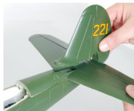
Zur Fertigstellung ist bei beiden Modellen das Seitenleitwerk am Rumpf anzukleben. Wie hier am Beispiel der P-39 zu sehen ist
