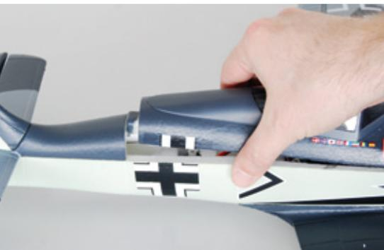
Die Rumpfoberseite inklusive der Kabinenhaube ist abnehmbar gestaltet und wird mittels zweier Magnete und eines Zapfensystems in Position gehalten. Hier zu sehen am Beispiel der FW-190
