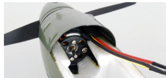
Der Brushlessmotor in der FW-190 und der P-39 hat eine spezifische Drehzahl von 1.950 kv und ist ab Werk bereits samt Motorträger in den Modellen verbaut
