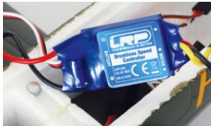
Der Motor der Speedbirds wird von einem programmierbaren 20-Ampere-Brushless-Regler angesteuert. Er ist für den Betrieb an 3s-LiPos ausgelegt
