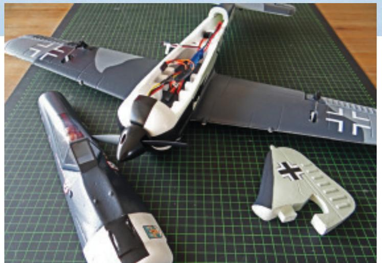
Durch die passgenaue Verzapfung ist die Montage des Leitwerks eine leichte Übung. Das Seitenruder ist nicht angesteuert.
