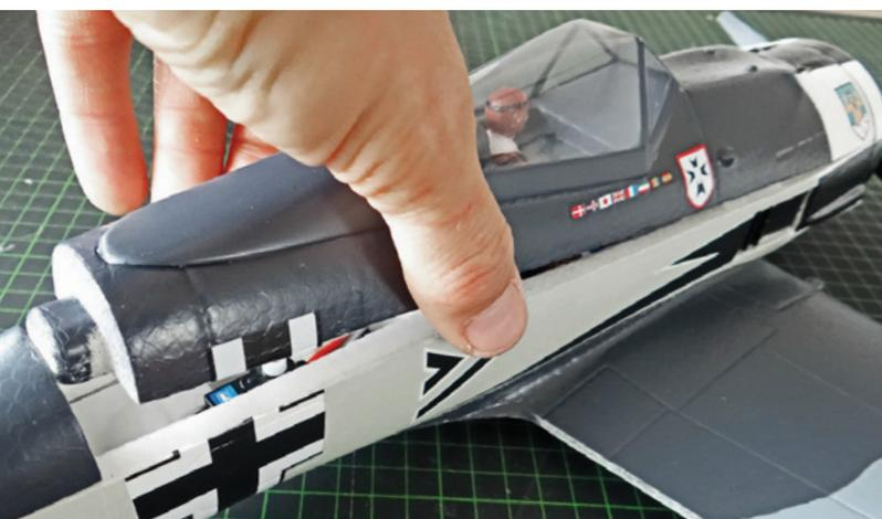
Der Deckel wird zuerst vorne unter die Motorhaube geschoben, dann wieder nach hinten gezogen und ist damit mit einem zusätzlichen Magneten sicher arretiert.
