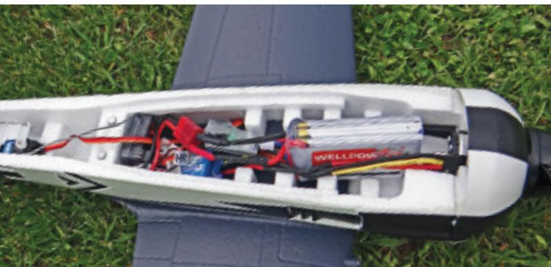
Hier zu sehen ist die Anordnung der Komponenten für den angegebenen Schwerpunkt mit einem 3s 1.000-mAh-Akku in der FW-190.
