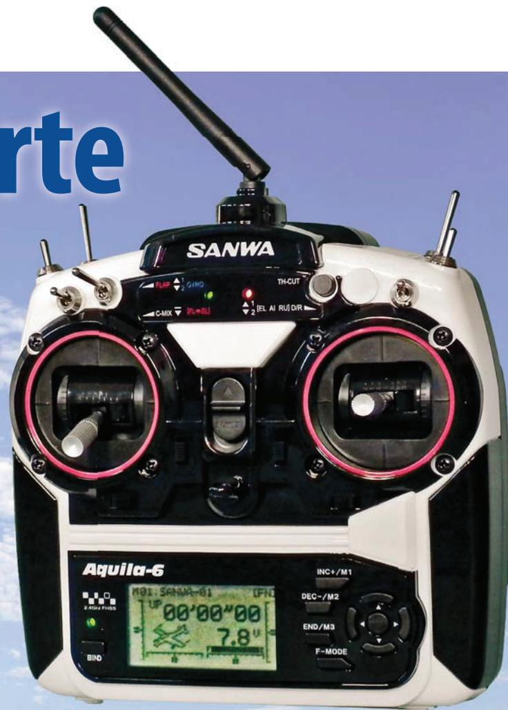
Die Leistungsdaten des Senders in Kurzform: Zehn Modellspeicher (löschen- und kopierbar), sechs Servokanäle mit einer Framerate von 24 ms, zwei leichtgängige präzise Kreuzknüppel mit je zwei Trimmrastern und längenverstellbaren Knüppelgriffen, acht teils mehrstufige Schalter/Taster, ein LCD-Display, Tastenkreuz mit fünf Kontakten (Navigationsspad genannt), vier Programmier- und eine zusätzliche Bindetaste.
