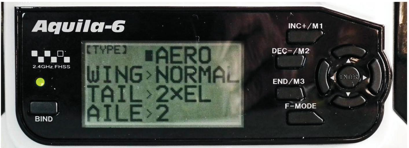
Die Programmierzone ist neben dem Display platziert, links der Bindetaster und rechts das Navigationspad mit den vier zusätzlichen Sondertasten.
